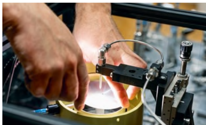
Messeinrichtung zum Bestimmen kleinster Flüsse.
