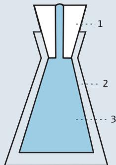
**Pyknometer** sind Wägegefäße, die zuerst leer und dann mit der zu messenden Flüssigkeit oder dem zu messenden Feststoff gewogen werden. Anhand der beiden Werte kann die Dichte berechnet werden.
