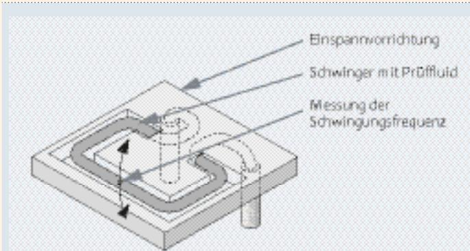
Der Omega-Chip zählt zu den **Schwinger-Dichtemessgeräten**. Bei dieser Methode bewegt sich ein Schwinger während er Kontakt zu dem jeweiligen Fluid hält. Dabei wird die Schwingfrequenz gemessen, die von der Dichte des Fluids abhängig ist.
